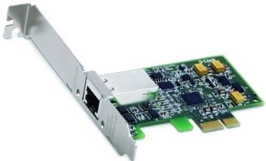
Figura 7: Placa Gigabit Ethernet em versão PCI Express
