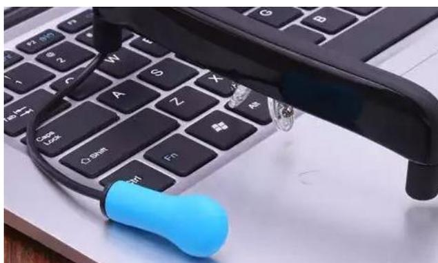
Figura 2.3: O sensor de mordida acoplado ao GlassOuse
