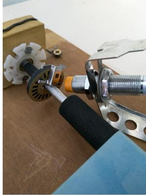
Figura 4.5: Sensor de proximidade e roda indutiva acoplada ao eixo
