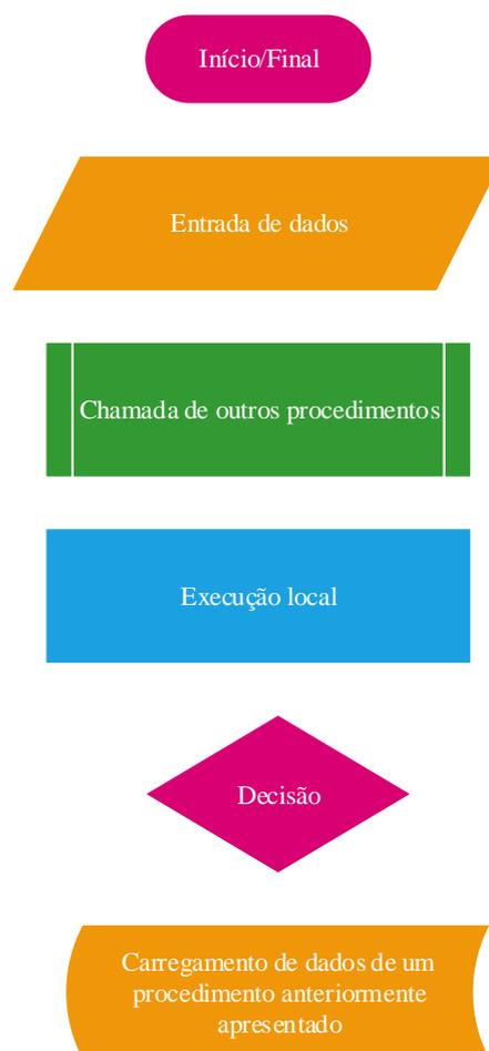
Figura B.1: Modelo dos fluxogramas.
