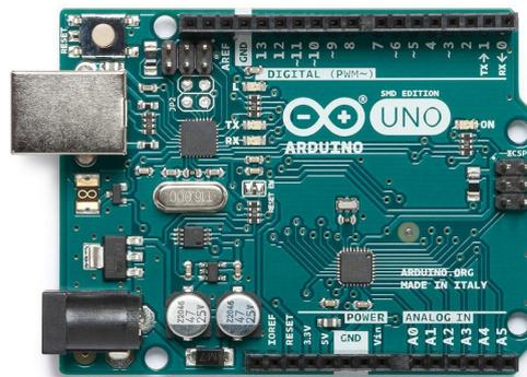
Figura 2.1: Microcontrolador Arduino UNO. Fonte (ARDUINO, 2019)
