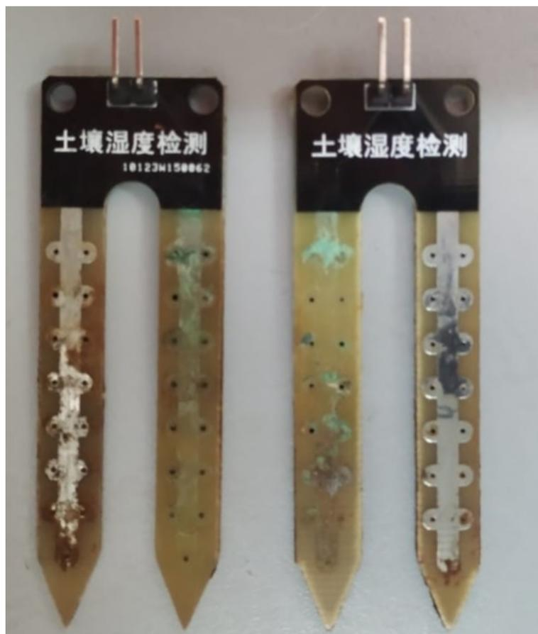
Figura 3.12: Sensores danificados.
