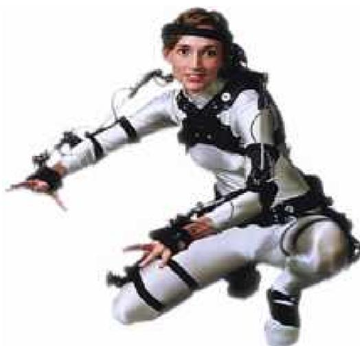
Figura 2.16 - Exemplo de um traje de captura de movimento mecânico.
