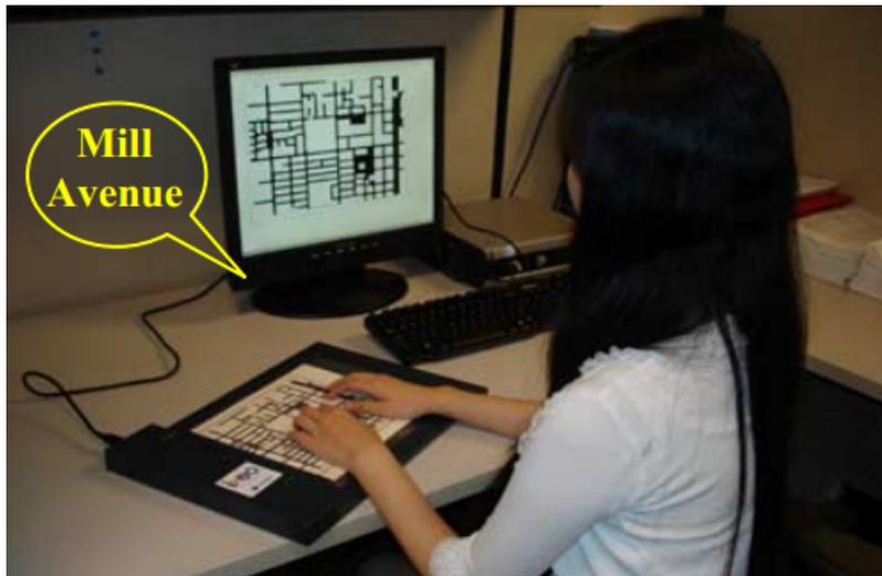
Figura 3.2: Usuário utilizando o sistema Instant Tactile-Audio map.
