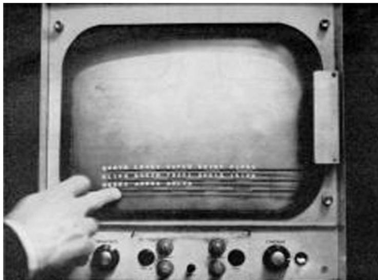
Figura 3.1: Dispositivo *touch screen* inventado por E. A. Johnson. Fonte: [17]
