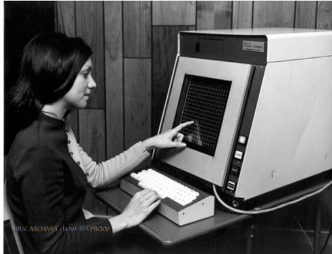
Figura 3.2: PLATO IV – Computador com tela sensível ao toque utilizando a tecnologia infravermelho.
