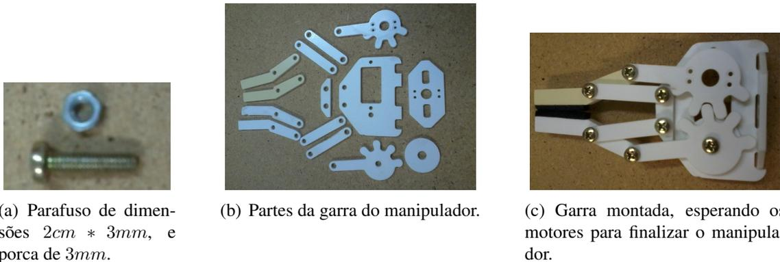
Figura 3.5: Ilustrações dos componentes do órgão terminal do tipo garra do manipulador.
