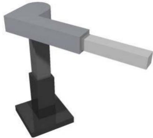
(b) Manipulador cilíndrico do tipo LVL.
