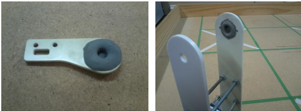
(a) Região do pulso com o encaixe de *Epóxi*. (b) Região do braço com o encaixe de *Epóxi*.
