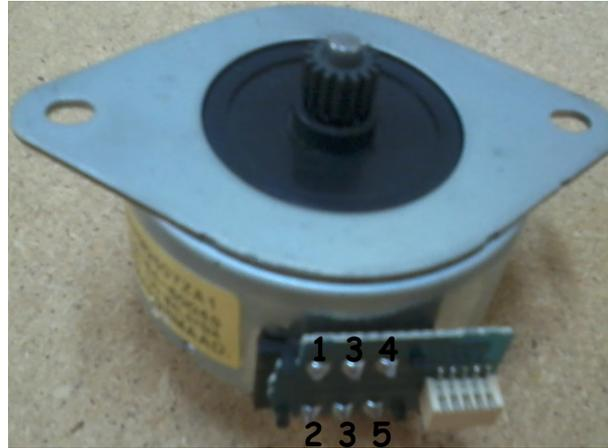
Figura 5.1: Motor de passo com 5 fios utilizado na base do manipulador construído.
