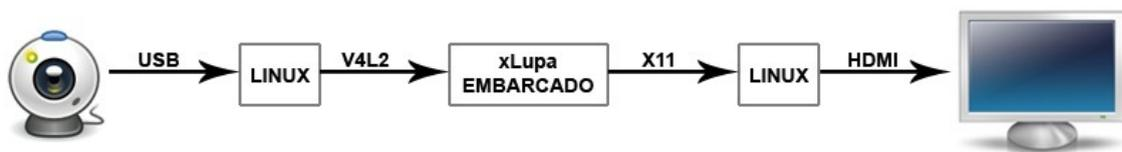
Figura 3.3: Fluxo de dados no xLupa embarcado
