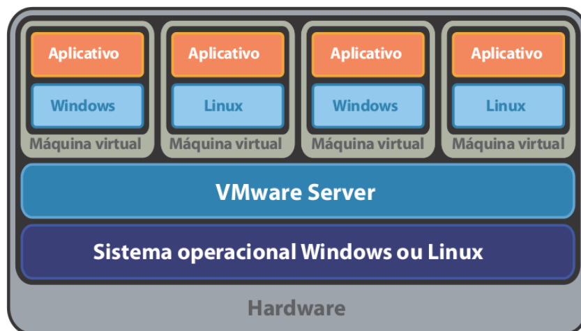
Figura 3.6: Modelo da arquitetura do VMware Server [7].
