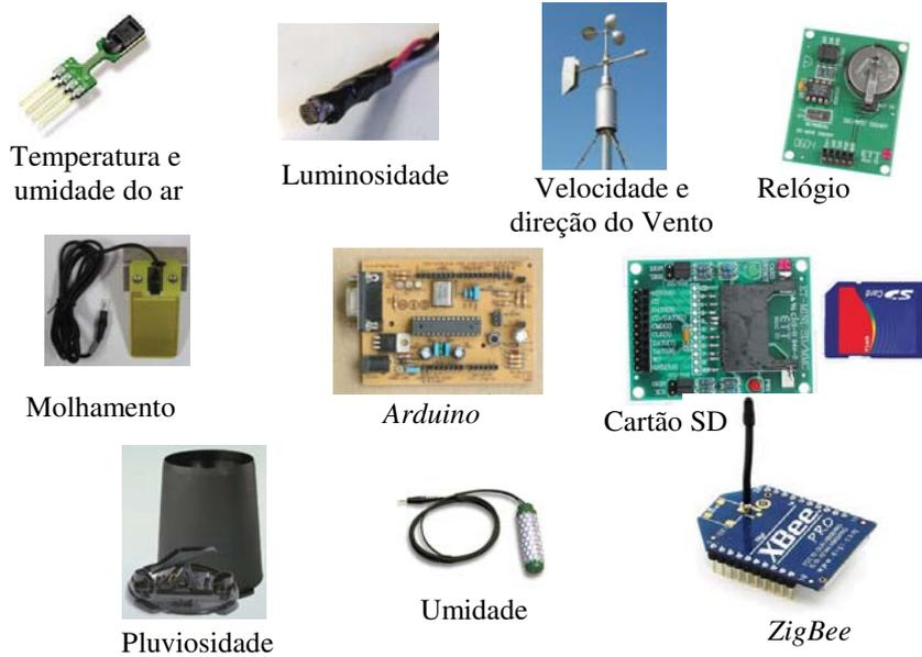
**Figura 4. Componentes da microestação**
