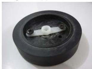
(a) Roda com o braço do servomotor
