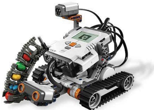
**Figura 2. *Shooterbot*, modelo base para o desenvolvimento dos controles [7]**
